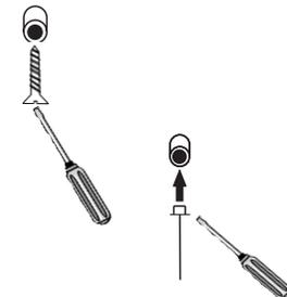
Com uma chave philips parafuse os fixadores de teto que acompanham o kit de instalação.
