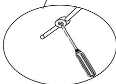
Aperte o prensa cabos com uma chave de fenda e corte o excesso do cabo de aço.
