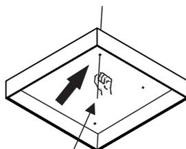
Passes os cabos de aço nos pontos de fixação.
